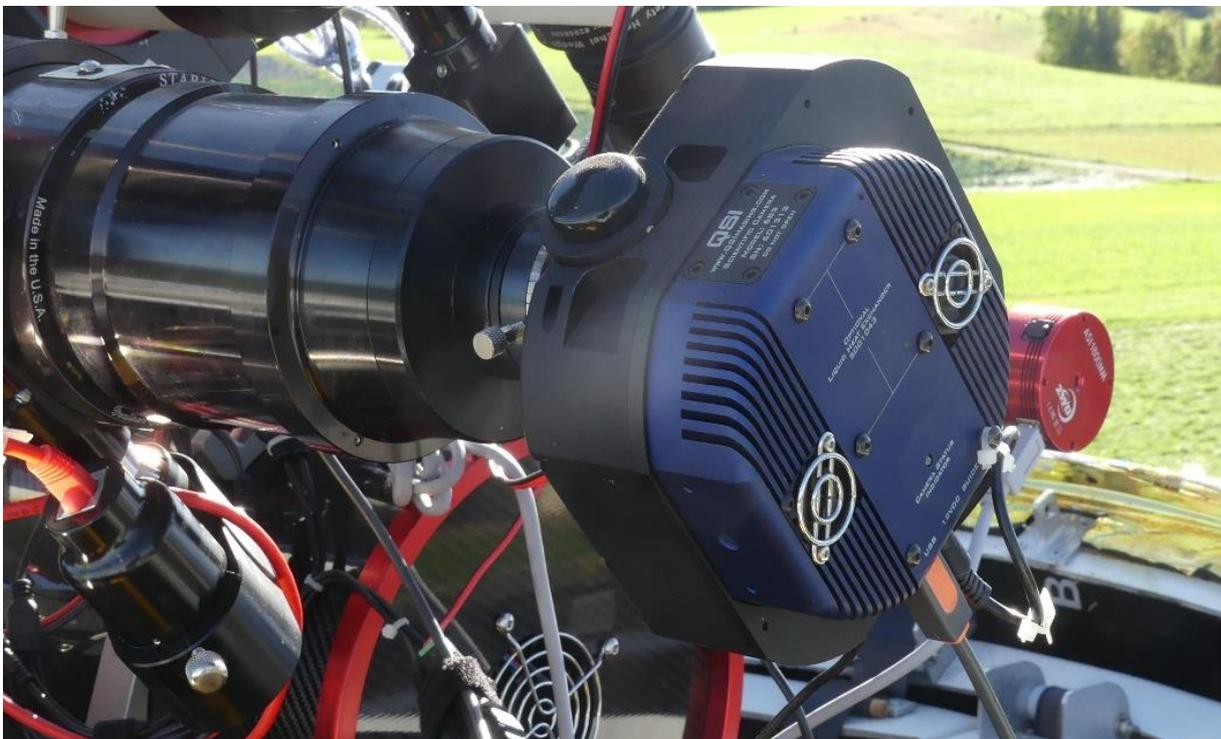
Abb. 4: QSI 683wsg-8 CCD Kamera am hinteren Ende des William Optics Refraktors. Das blaue Gehäuse beinhaltet den Bildsensor, die Elektronik sowie die Kühlung. Das vorgelagerte schwarze Gehäuse beinhaltet das Filterrad mit 8 Filtern.
